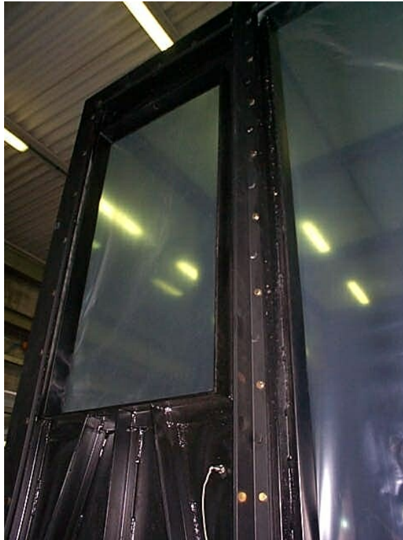
Fig. 2.1.2 – Particolare del vent della parete di prova della CVE con porta e finestra in plastica
