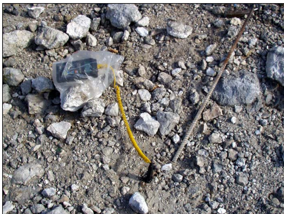
Figura 8.9: la sonda infissa nel terreno e la termocoppia durante un rilevamento di T.
