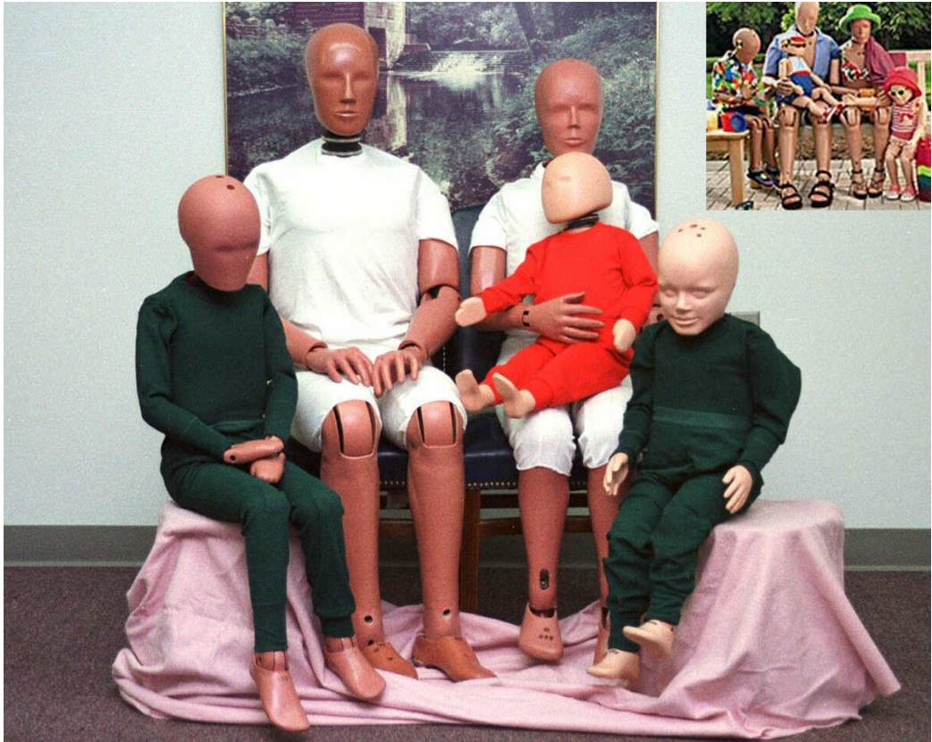
Figura 1.7: Famiglia Hybrid III. Questi manichini prodotti dalla General Motors sono tra i più utilizzati nei crash test dalle case automobilistiche per la loro elevata sensorizzazione e la somiglianza all'individuo medio.
