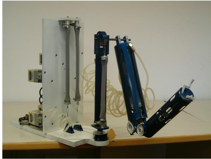
Figura 5.6: Manipolatore attuato mediante muscoli artificiali di McKibben realizzato presso il Centro Interdipartimentale di Ricerca “E. Piaggio”.
