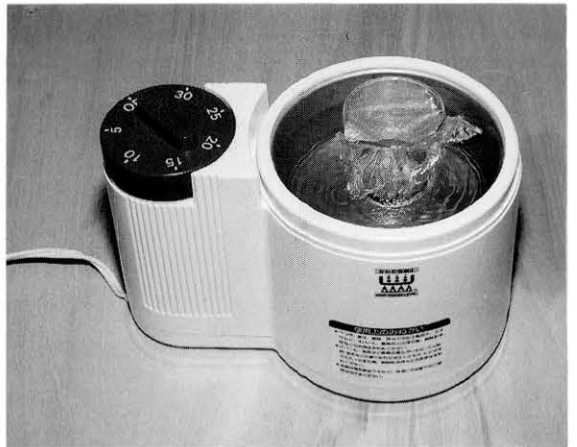
図83 超音波発生装置による膠の調整 Adjusting animal glue in an ultrasonic apparatus
