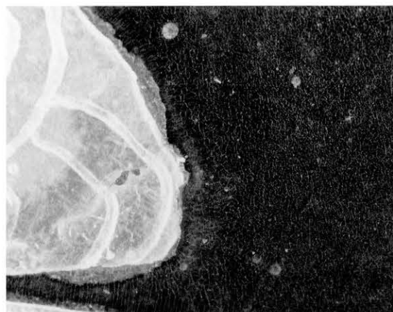
図76 螺鈿の毛彫りとマイクロクラック Engravings on the raden and minute cracks
