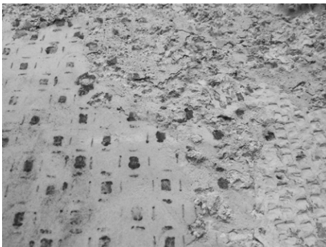
図30 図25中②硝酸ナトリウムの消失 (2014年12月9日)
