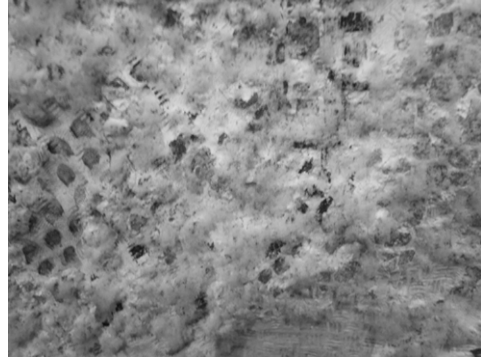
図27 図26拡大(図25中①硝酸ナトリウムの析出) (2013年9月18日)
