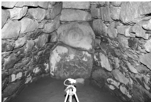
図3 石室内の温湿度計測（古畑古墳）
