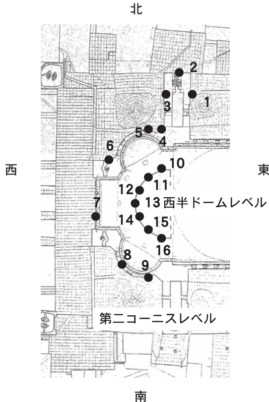
図3 西側外壁の削れ程度の計測場所
