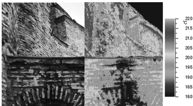
図9 第2コーニス北西部の可視画像(左)と熱画像(右)(94の外)(口絵参照)
