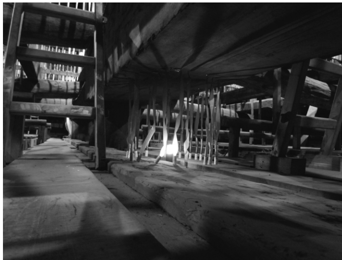
写真6 Uエリア（三仏堂小屋裏，牛梁の下）に設置したLEDライト 2011年7月22日よりLEDライトを設置（24時間連続照射）。
