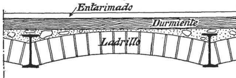
Fig. 831. — Bovedillas de ladrillo ordinario macizo.
