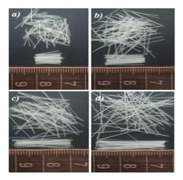
Fig.1. Different loose fibres (a) L=10 mm,( b) L=15 mm,( c) L= 20 mm, (d) L=25 mm \*mm=0.0394 in
