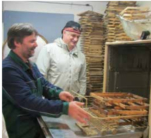
Kuva 10. Sulatetut kehät pestään erityisessä pesukoneessa, johon tulee +80 asteista vettä ja 2 %:n NaOH-liuos.
