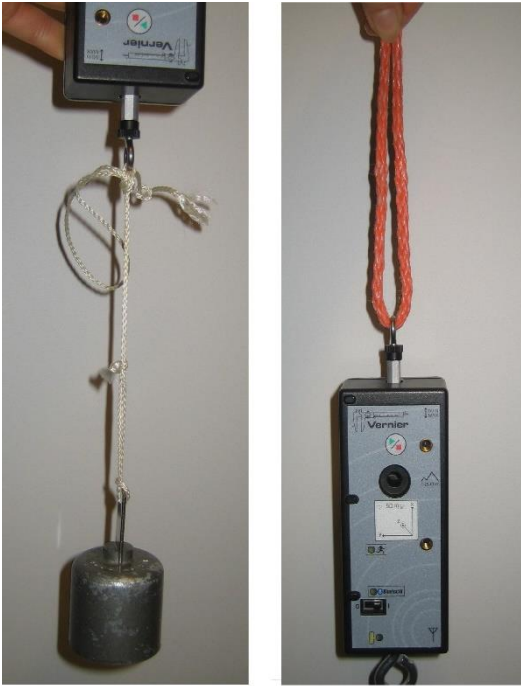
Kuva 13: Vasemmalla koejärjestely erillisellä punnuksella ja oikealla anturia käytetään punnuksena.
