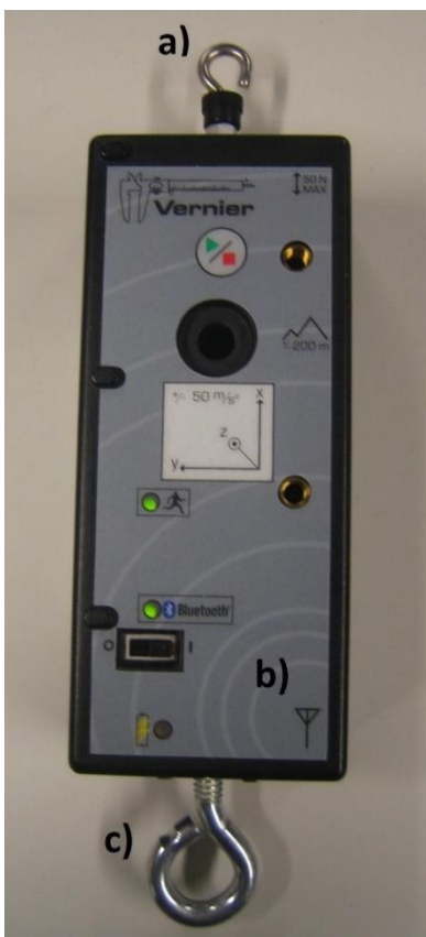
Kuva 4: WDSS-anturi a) voima-anturin koukku b) bluetooth-antennin paikka c) ripustuskoukku.
