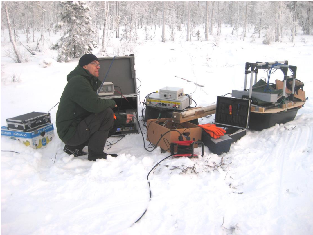
Kuva 42. Sampo-mittausta vuonna 2016 Pohjois-Suomessa. Sampo-menetelmä on laajakaistainen sähkömagneettinen taajuusluotausmenetelmä, jolla nykyisellään voidaan mitata jopa 1500 metrin syvyydellä olevia johteita. Kuvassa Jarkko Jokinen. Kuva: GTK.
