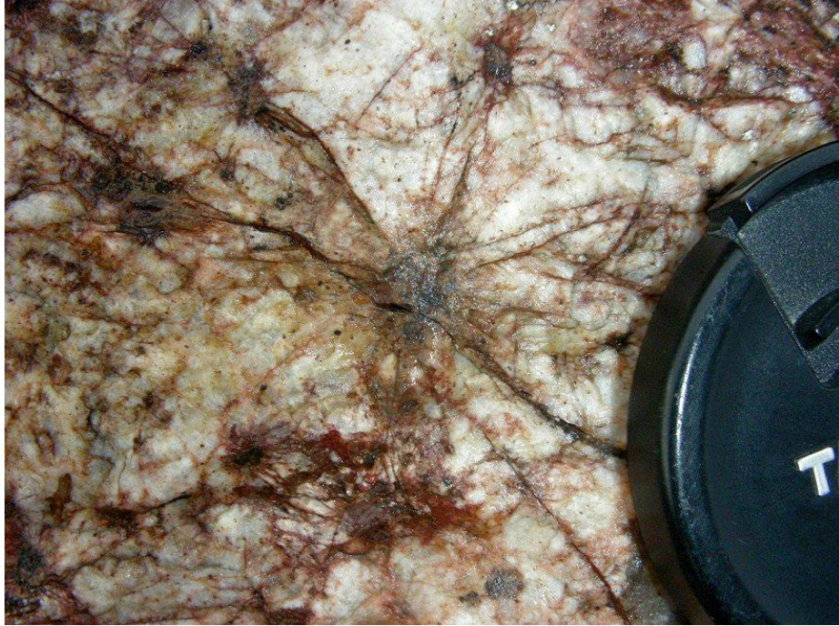
Kuva 47. Kuvassa on keskellä allaniitti-Ce eli ceriumpitoista allaniittimineraalia. Allaniitti on monoklininen mineraali, joten sen kiderakenne on hajotessaan synnyttänyt rikkoutumisrakenteita ympärillä olevaan maasälpään. Tämä säteittäinen rikkoutumisrakenne toimii tunnistamisen apuna. Allaniittiosueen koko noin 1 cm. Längelmäki. Satu Hietala GTK.
