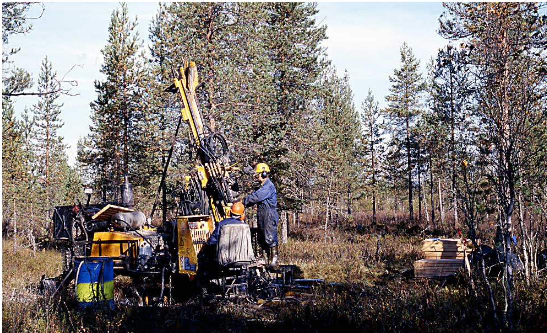
Kuva 39. Talkkiesiintymän kairaus GM100B kairauskoneella. Paikka Alanen, Rautavaara. Jari Väätäinen, GTK.
