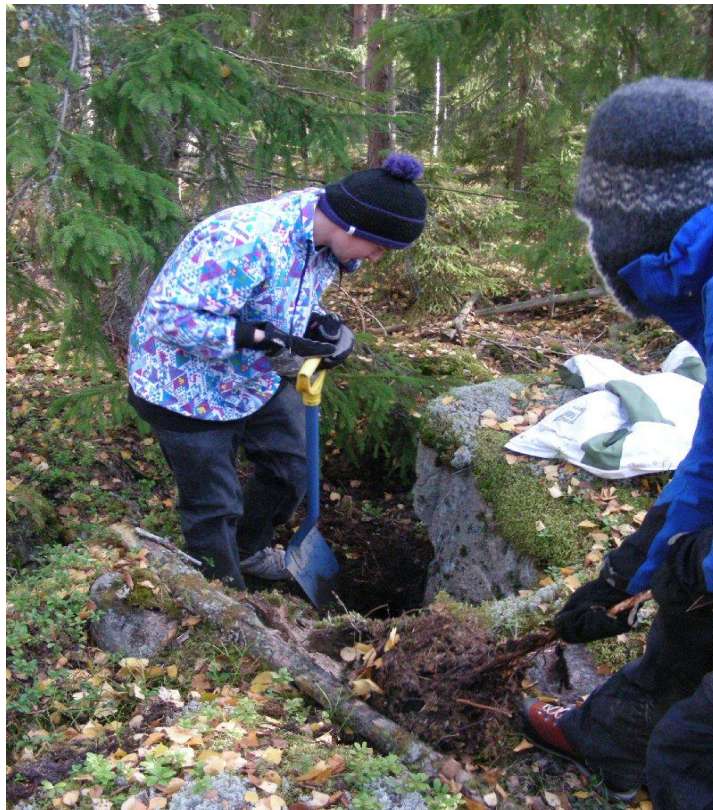
Kuva 36. Lapionäytteenottoa humuksen alta pintamaakerroksesta. Näytteenottosyvyys on noin 50 cm. Satu Hietala, GTK.
