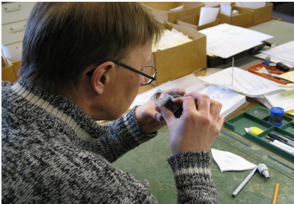
Kuva 23. Kivinäytteiden alustava arviointi tapahtuu perinteisesti kovuuden, viirun, magneettisuuden sekä luupin avulla tutkimalla. Jari Nenonen, GTK.
