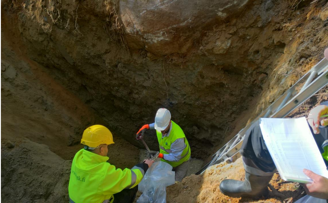
Kuva 37. Raskasmineraalinäytteenottoa moreenista tutkimusmontusta noin 5 metrin syvyydeltä. Satu Hietala, GTK.
