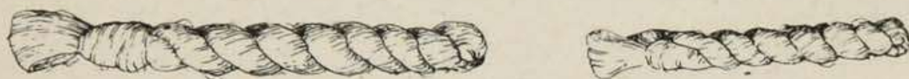
FIG. 67 et 68. — Pliage à l'européenne des flottes de grège.
