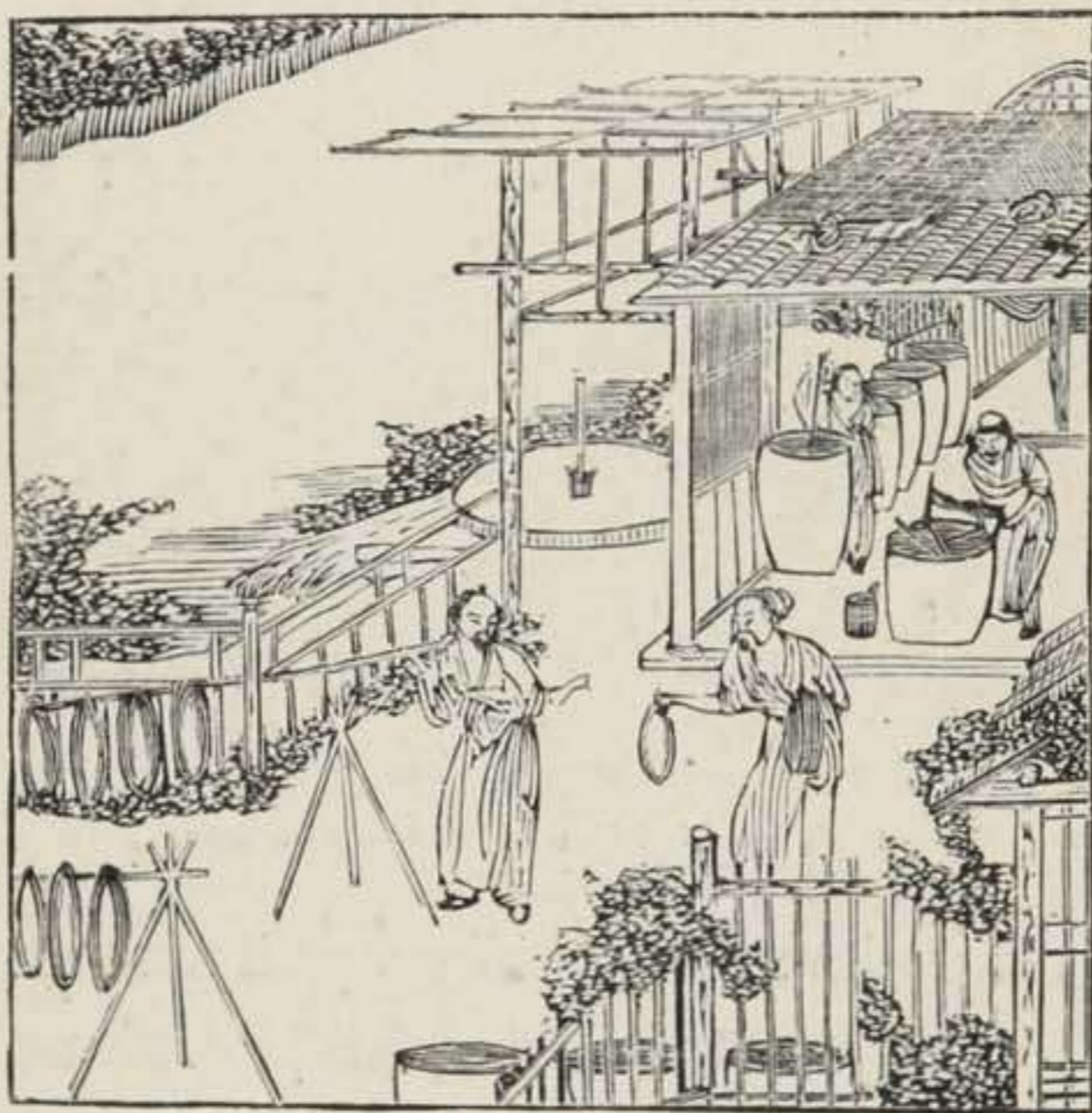
FIG. 104 — Atelier de teinture en Chine. Cuves, chevilles pour tordre ou pour étendre les soies.
