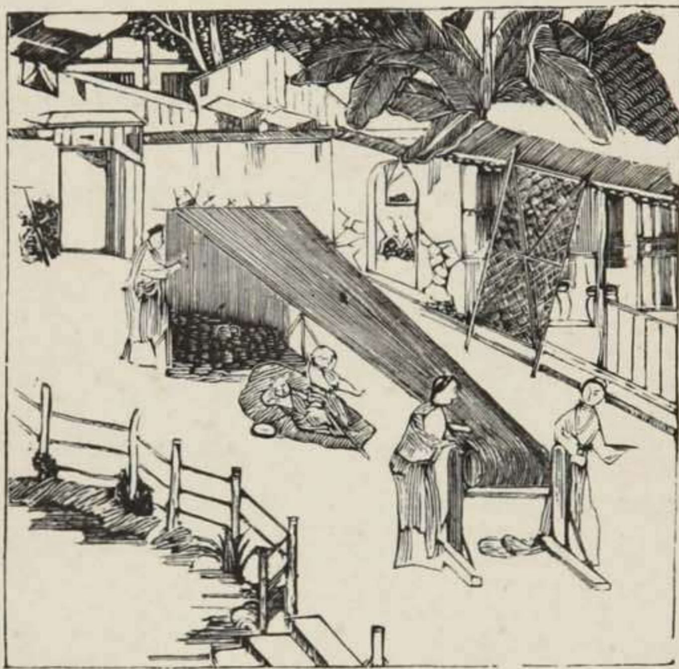
FIG. 111. — Ourdissage en Chine : il y a autant de roquets que de fils de chaîne.
