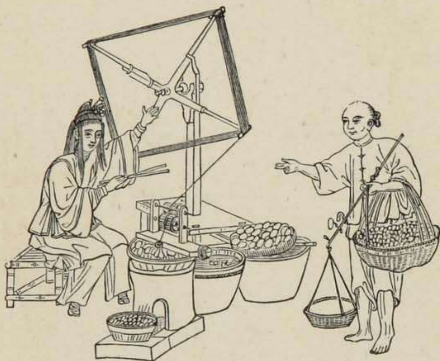
FIG. 58. — Bassine primitive chinoise pour le tirage des cocons.
