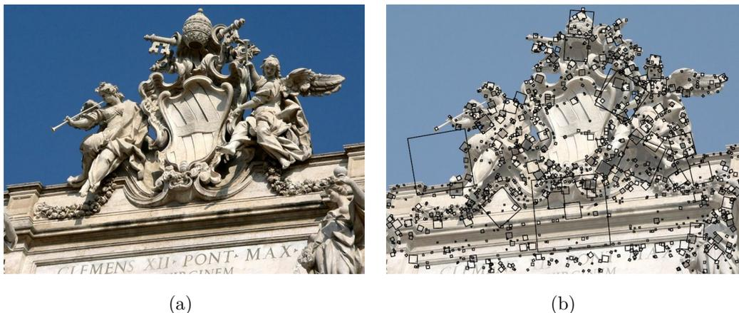
Abbildung 2.17: Der SIFT-Algorithmus [SSS06d]: (a) Eingabebild. (b) Die Ergebnisvektoren der Feature-Points sind in das Bild als Quadrate eingezeichnet. Die Skalierung eines Quadrats kodiert die Größe des Bildmerkmals im Eingabebild. Die Rotation eines Quadrats kodiert die Orientierung des Bildmerkmals im Eingabebild. Der Mittelpunkt eines Quadrats kodiert die zentrale Position eines Bildmerkmals im Eingabebild.
