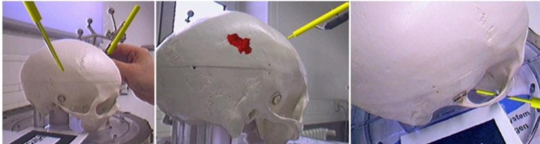
Abbildung 3.17: Authentische Verdeckung von AR-gestützten medizinischen Apparaturen auf der Basis von gegebenen 3D-Modelldaten der medizinischen Instrumente [FBS04].
