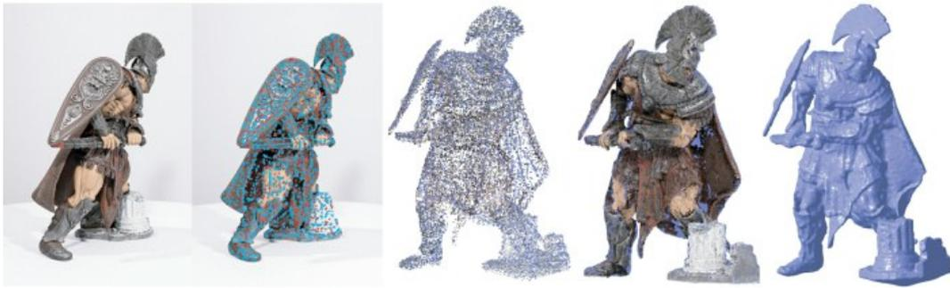
Abbildung 3.5: Übersicht der einzelnen Schritte des PMVS-Verfahrens vom Eingabebild zur resultierenden konvexen Hülle [FP10].
