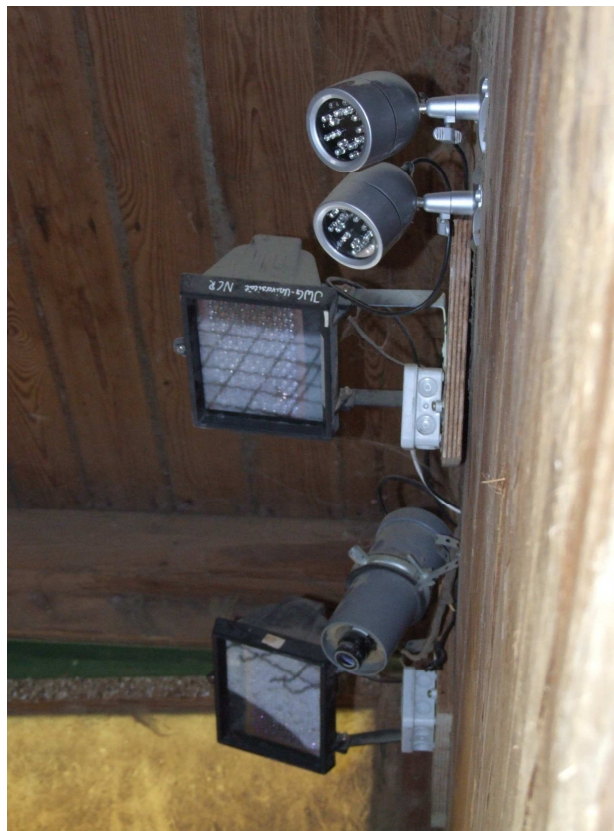
Abb. 3.13: Die im „alten Giraffenstall“ des Opel-Zoos verwendete Videotechnik. Besondere Aufmerksamkeit verdienen die im Arbeitskreis NCR entwickelten und hergestellten Infrarot-Scheinwerfer (links im Bild).
