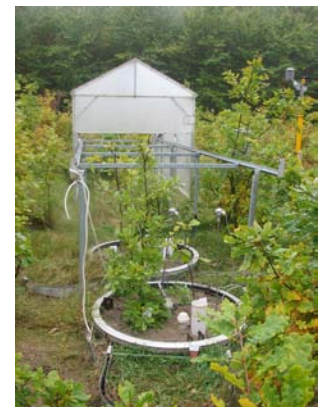
Abb. 6: (links) Wägbares Lyssimeter in einem Kiefern-Buchen-Mischbestand.
