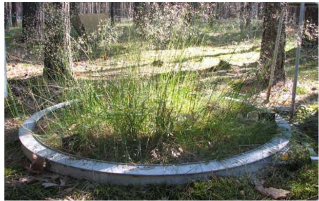
Abb. 5: Wägbares Lyssimeter mit Bodenvegetation in einem Kiefernreinbestand.
