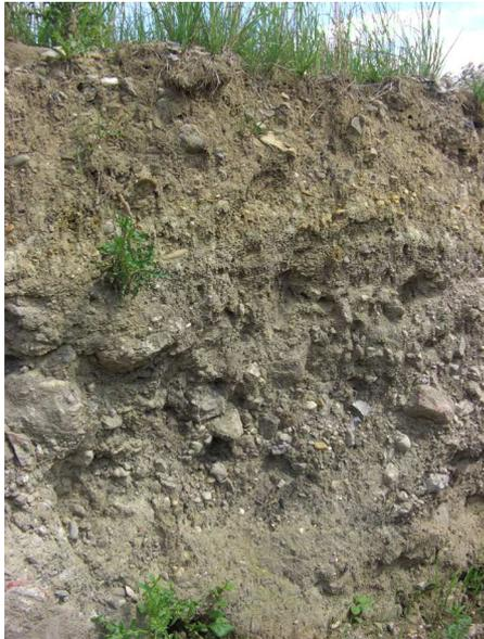
Abb. 3: Auftragsboden aus sandigem Lehm mit hohem Gehalt an Kies und technogenen Beimengungen (verschiedene Schlacken, Asche, Glas, Ziegel) auf einer Brachfläche am Stadthafen Essen (2011, T. KASIELKE).
