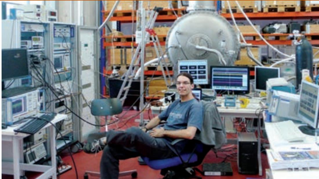
Holger Podlech mit seinem Messaufbau zum Test der supraleitenden CH-Struktur in der Experimentierhalle des Fachbereichs Physik. In der oberen Bildmitte ist der Kryostat zu erkennen, in dem die Kavität mithilfe flüssigen Heliums auf  $-269$  Grad abgekühlt wird.
