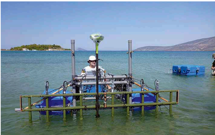
Prospection magnétique en mer, à faible profondeur – Magnetische Prospektion in untiefen Bereichen des Meeres.
