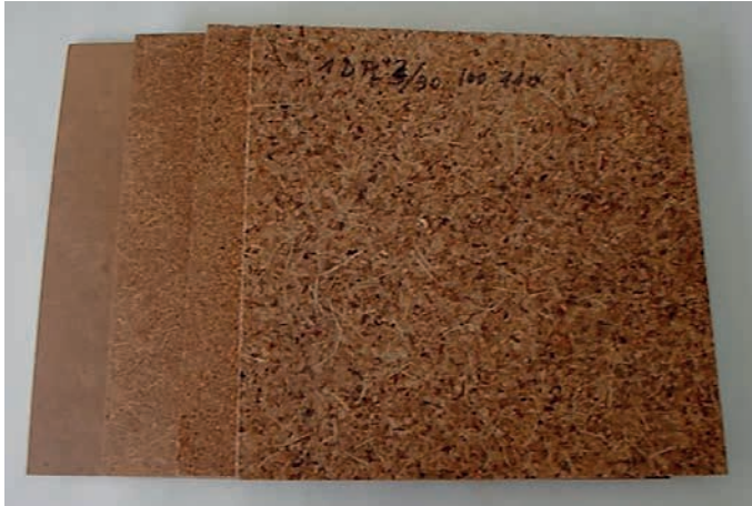
Figura 6. Tableros sin adhesivos de tronco de palmera canaria.
