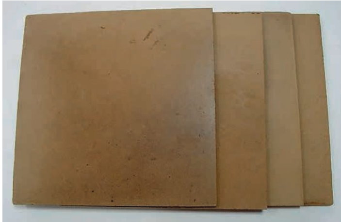
Figura 11. Tableros estructurales de cemento – caña.
