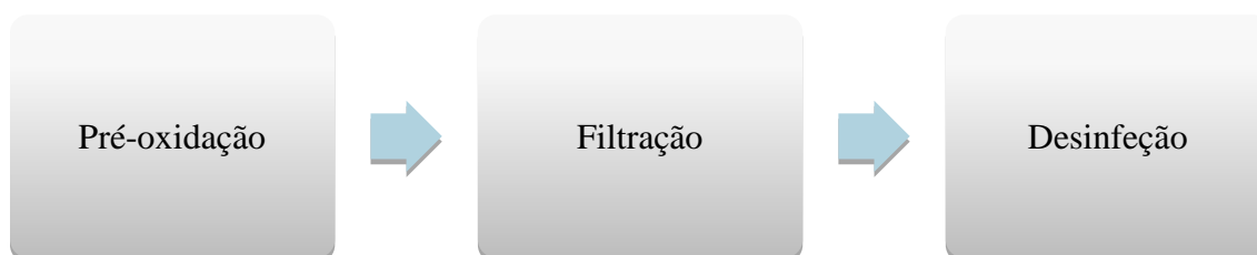
Fig.2: Esquema tipo de tratamento de águas subterrâneas em Portugal (15).
