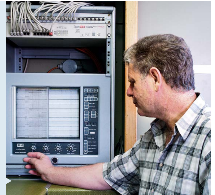
Echolot an Bord des Forschungskutters LITTORINA (bis 2014 im Einsatz)
