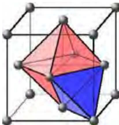
Figure III.6 : Sites interstitiels dans un réseau cubique à faces centrées : site octaédrique (rose) et site tétraédrique (bleu).
