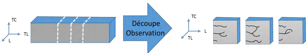
Figure III.2 : Méthodologie mise en place pour analyser la morphologie des défauts de corrosion intergranulaire pour l’alliage d’aluminium 2024
