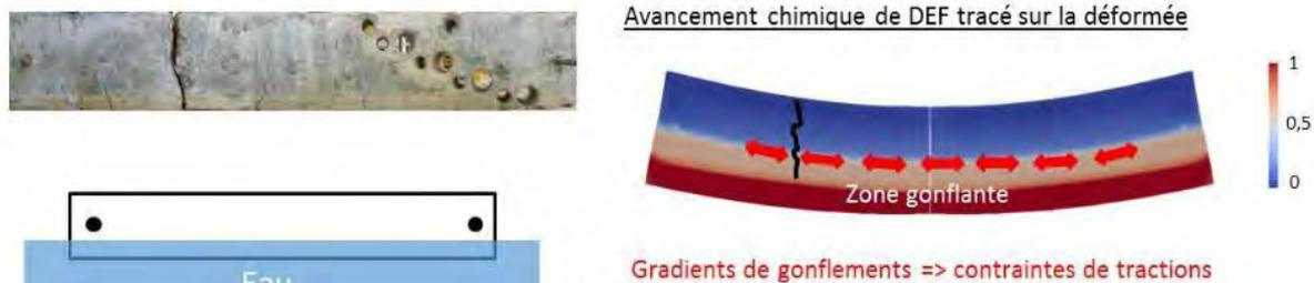
Figure 3-36 : Rupture de la poutre non armée, photographie issue de (Martin 2010)
