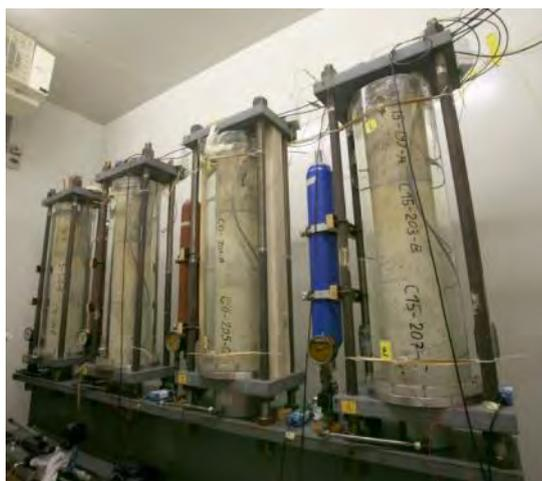
**Figure 1-22 : Eprouvettes immergées de (Dunant, 2009)**
