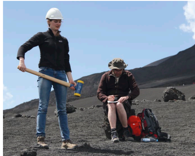
Mit dem Hammer simulieren die Planetenforscher Meteoriteneinschläge auf dem Mond. Die Abfolge der Schläge wird genau notiert.
