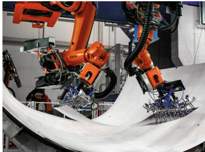
Zwei Roboter legen kooperierend das Aluminium ab
