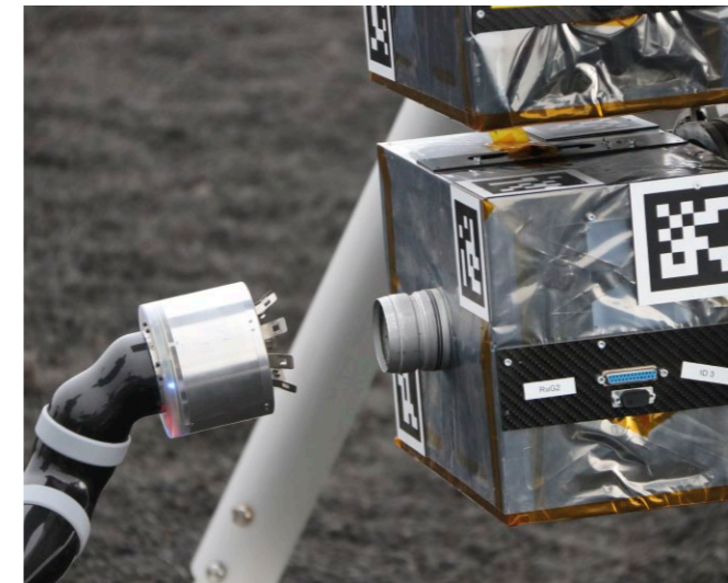
Sieht einfach aus – ist es aber nicht: Der Rover blickt auf die Sensorbox (rechts) und bewegt dann seinen Greifer (links) zum Verbindungsstück.
