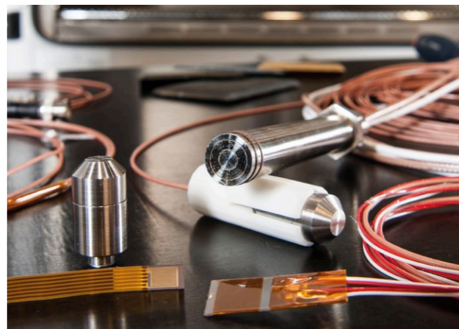
Sensoren wie die im Bild sichern die Qualität des Bauteils, während es im Autoklav aushärtet
