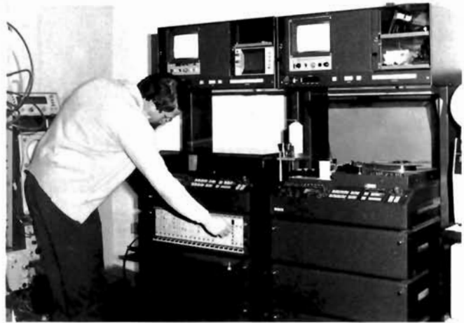
DAS HERZ der gesamten Videoanlage ist der Maschinenraum mit der Steuerzentrale und den 1-Zoll-B-Norm Bandaufzeichnungsgeräten.
