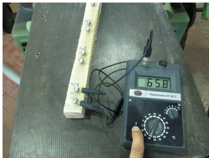
Figura 22 – Medição do teor de água dos provetes – Método elétrico.
