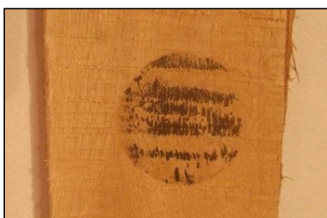
Figura 43 – Manchas na zona de colocação dos grampos.
