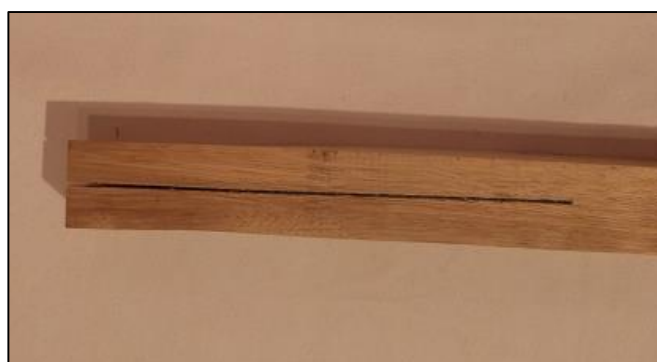
Figura 41 – Teste de Prong aos provetes em estudo.
