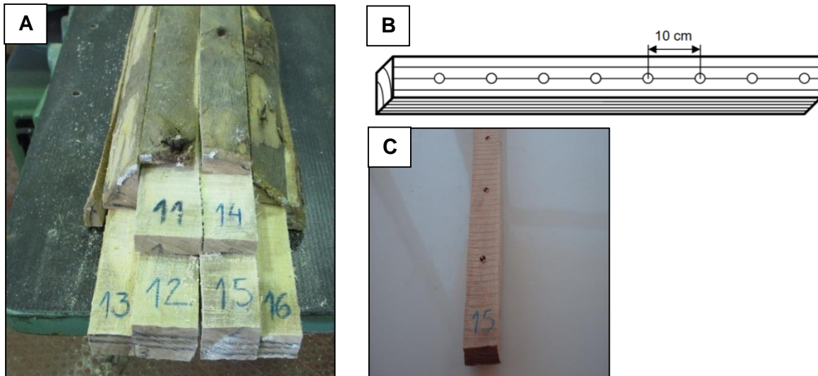
Figura 27 – (A) Aproveitamento de meio toro em 6 provetes de dimensão distinta; (B) Esquema dos furos feitos em cada provete; (C) Resultado dos furos aplicados em um dos provetes.
