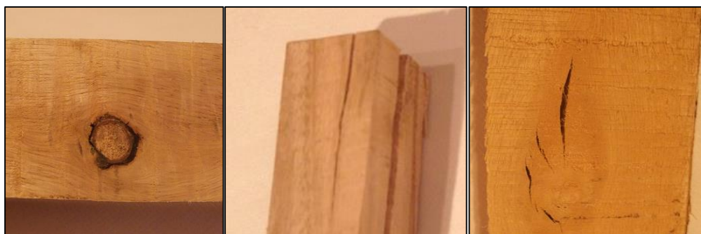
Figura 44 – Defeitos extrínsecos à secagem de madeira – Nós e fissuras.
