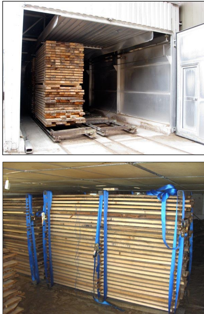
Figura 11 – Em cima: Secador industrial (Cortesía: Volgger OHG); Em baixo: Pilha de secagem de eucalipto em secador solar (Fonte: Santos, 2013).
