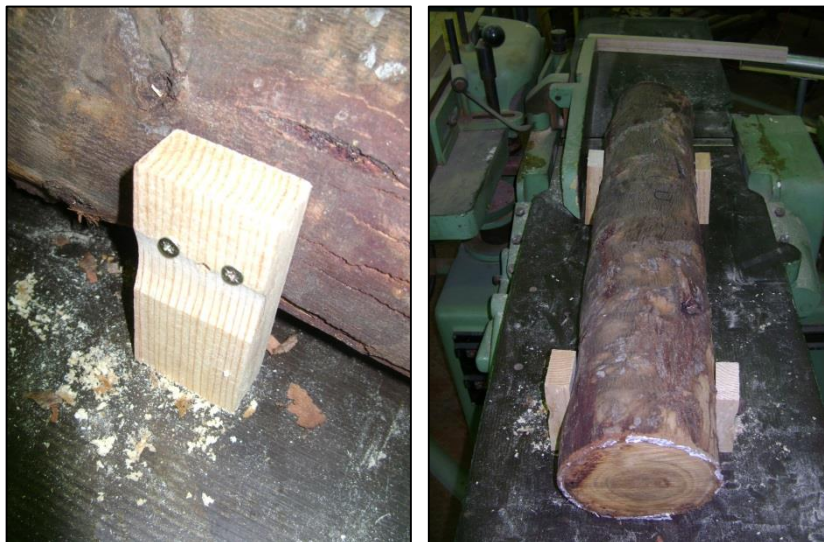
Figura 18 - Sistema de suporte de toros improvisado, com vista a ultrapassar a dificuldade de abertura de toros de pequeno diâmetro.
