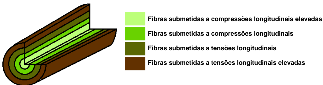
Figura 6 – Modelo teórico da distribuição das tensões de crescimento no interior de um toro (Fonte: Adaptado de - Vázquez, 2001).
