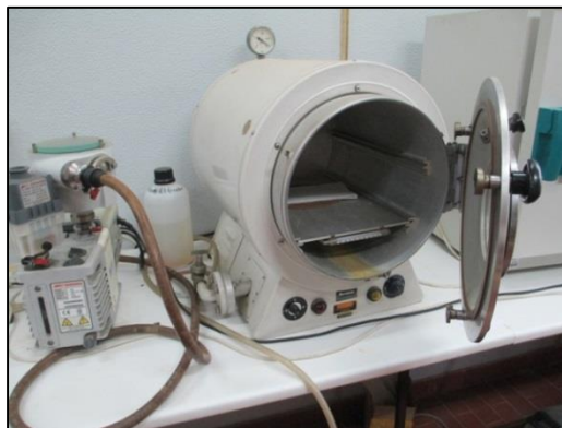
Figura 30 – Sistema de vácuo laboratorial utilizado durante o ensaio 4. (Fonte: Santos, 2013)
