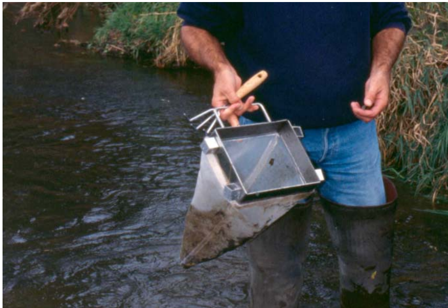
Abbildung 11: Surbersampler zum Fangen wirbelloser Kleintiere aus der Ron.
