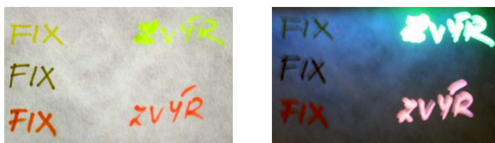
Filzstift- und Textmarkerschriftzüge auf Filterpapier bei Tageslicht (links) und unter UV-Licht (rechts)
