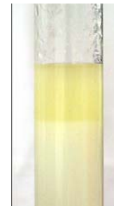
Phasentrennung bei der Rapsöl-Umesterung
