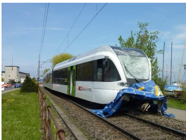
Abbildung 38: Unfall in Goldach, der Zug entgleiste mit dem vorderen Drehgestell. Bildquelle [21]
