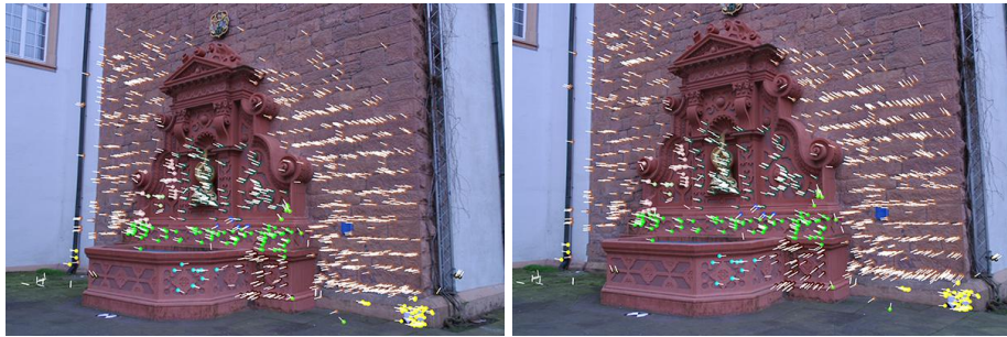
5. ábra. Érintősíkukhoz rendelt megfeleltetések a fountain-P11 első két frame-én. A síkokat színek jelölik, a felületi normálisokat pedig fehér szakaszok.
