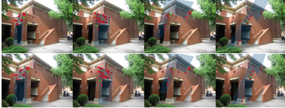
2. ábra. A felső és alsó sorban levő képek a johnsona teszt két képe. A kék színű poligonok homográfiákat vizualizálnak, melyek egybeesnek (első két oszlop) vagy nem esnek egybe (második két oszlop) érintősíkokkal. A megfeleltetés, amelyből az adott homográfiát becslünk, zölddel van jelölve. A \epsilon -küszöböléssel kapott inliereket pirossal jelöltük, ahol \epsilon = 3.0 pixel.
