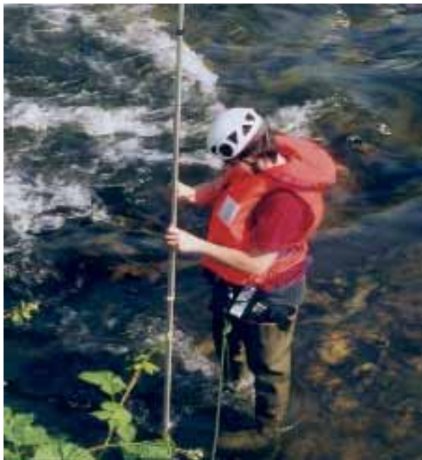
Abb. 2.38: Flügelmessungen zur Fließgeschwindigkeitsbestimmung auf einer Rampe.
