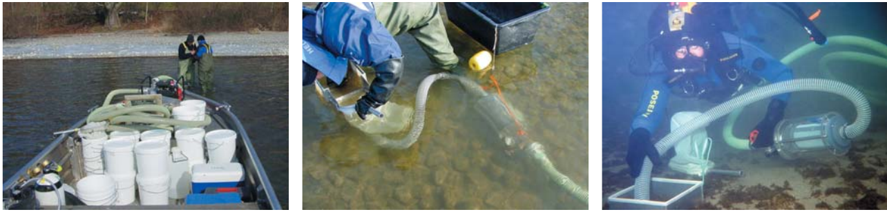
Abb. 3.2.1: Ablauf der Intensivprobenahme, links und Mitte: im Bereich des mittleren Niedrigwassers; rechts: im größeren Tiefen mit dem Taucher. Fotos: Scheifhacker, Fiek, Mörtl
