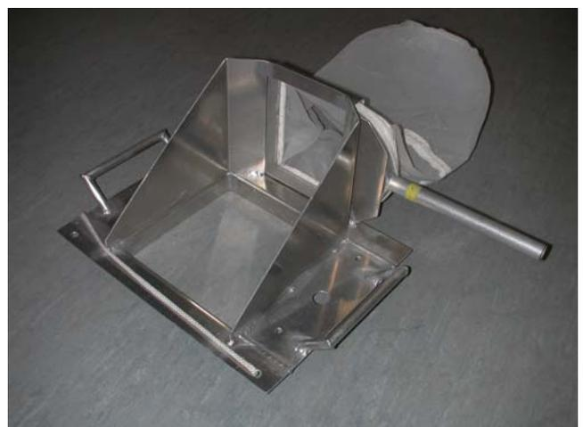
Abb. 7: Probennahmegerät für strömende Untersuchungsstellen.
