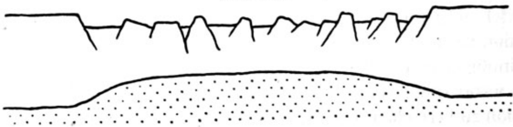
Größerer Einbruch durch Dehnung der Unterlage (schematisch).
