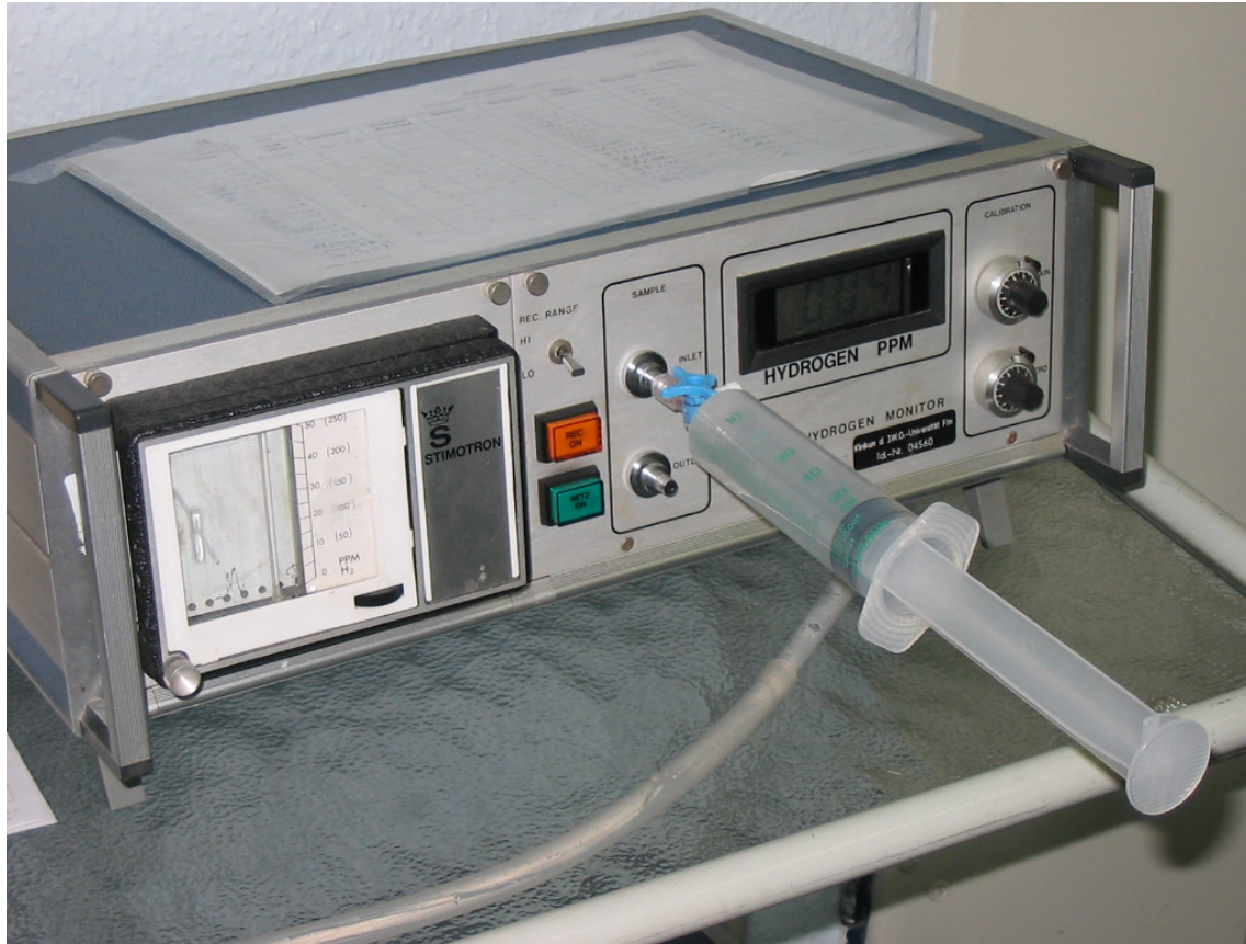
Abbildung 6: H 2 -Atemtest-Analysegerät mit Perfusorspritze, Stimotron Medical, Wendelstein, Deutschland
