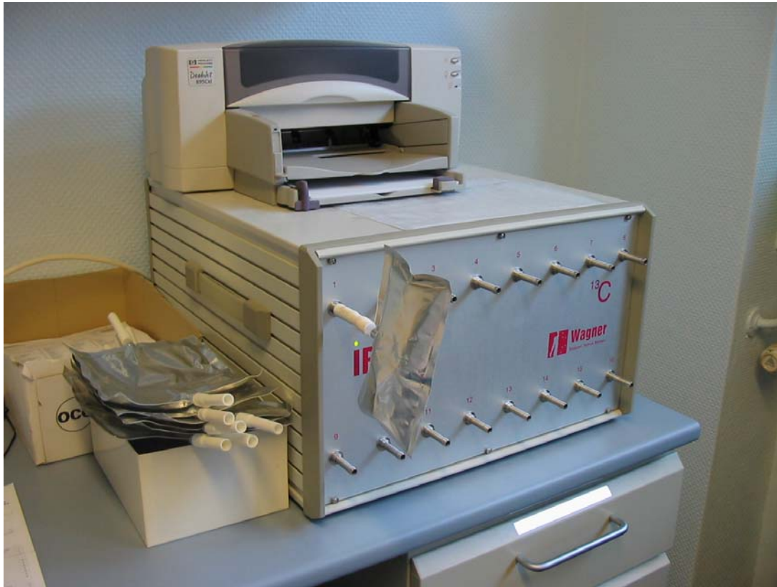
Abbildung 11: IRIS-System mit Doppelkammerbeutel (Wagner Analystechnik, Bremen)
