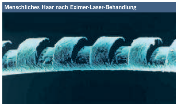
Menschliches Haar nach Excimer-Laser-Behandlung [2] Die hohe Präzision, mit der ein Excimer-Laser Gewebe abtragen kann, wird an einem Haar verdeutlicht. 1 Laserpuls entspricht 0,25 µm Hornhautgewebe (1000 µm = 1 Millimeter).
