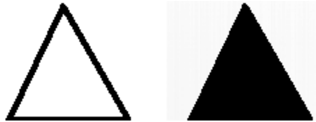
Abb. 4. Beispiel für die Hole-Filler Verarbeitung; links: Anfangszustand; rechts: Resultat nach Anwendung der Optimierung auf dem EyeRIS™ System.
