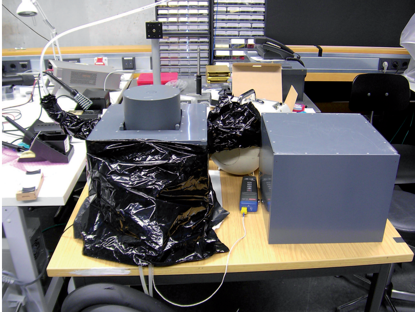
Abbildung B.2: Geöffneter Messaufbau; In der „Dose“ in der Mitte der Kisten befinden sich die Strahlungsquelle sowie die APD.
