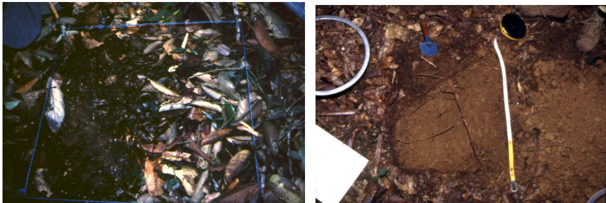
Abb. 3.3.2: Linkes Photo: Die eine Hälfte der ¼ m² Arbeitsfläche ist mit Laubstreu bedeckt und die andere zeigt die unter der Laubstreu liegende Humus-Wurzel-Schicht (HWS). Rechtes Photo: Von der ¼ m² Arbeitsfläche wurden Laubstreu und HWS entfernt sowie der Oberboden bis in 20 cm Tiefe abgetragen.
