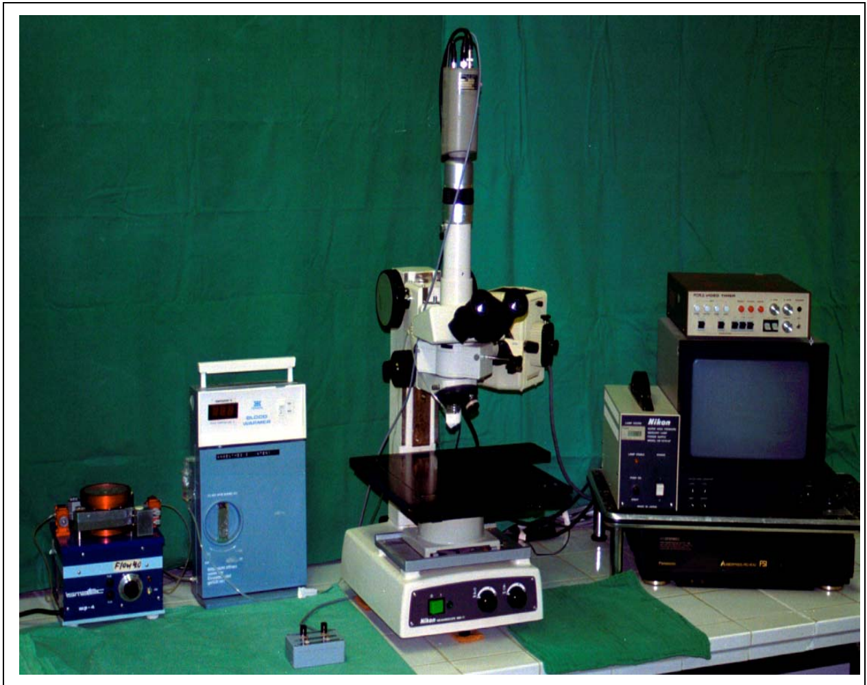
Abb. 4.10: Technische Ausstattung zur Intravitalmikroskopie: Mikroskop, Kamera, Echtzeitgenerator, Monitor und Videorecorder
