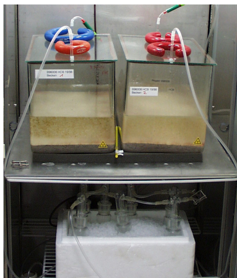
Abb. 6: Versuchsanordnung zur Bioakkumulation in Tubificiden.
