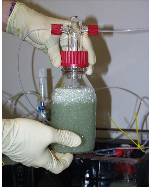
Abb. 3: Waschflasche mit HCB-beschichteten Glasperlen zur Dotierung des Wasserkörpers.
