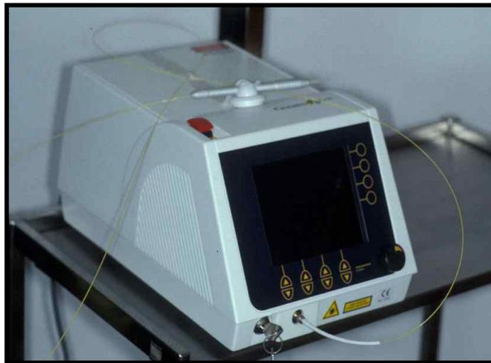
**Abb. 12: Diodenlaser (980nm) mit angeschlossener Glasfaser.**
