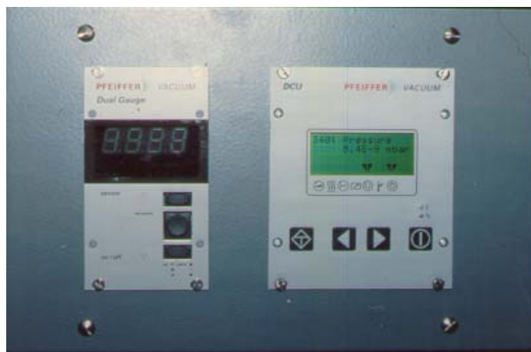
Abb. 35: Vakuum-Controller (li.) und Controller der Turbopumpe (re.)
