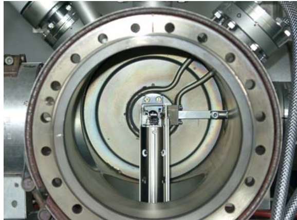
Abb. 26: Massenspektrometerkopf mit Blende (im Hintergrund)
