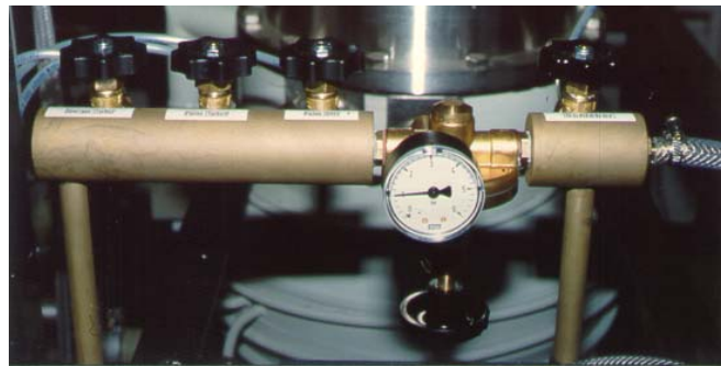
Abb. 39: Verteiler für Betriebsgase ( N_2 )
