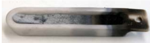
Abb. 81: Schiffchen mit getempertem Si-Pulver
