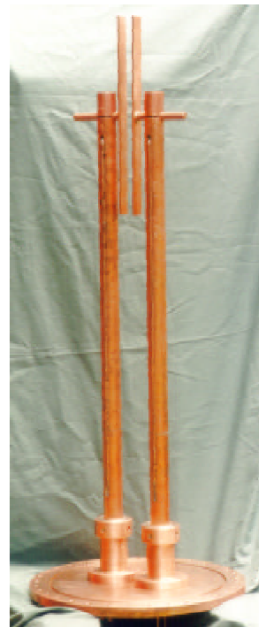
Abb. 6.11 zeigt links ein Modell als \lambda/4 Resonator, rechts ein Foto des Einzellen-Funneling-Deflektors. Der Resonator besteht aus einer Grundplatte mit direktmontierten wassergekühlten Stützen, die Ablenklatten können über Klemmungen im Abstand variiert werden. Die Höhe ist ca. 2 m.
