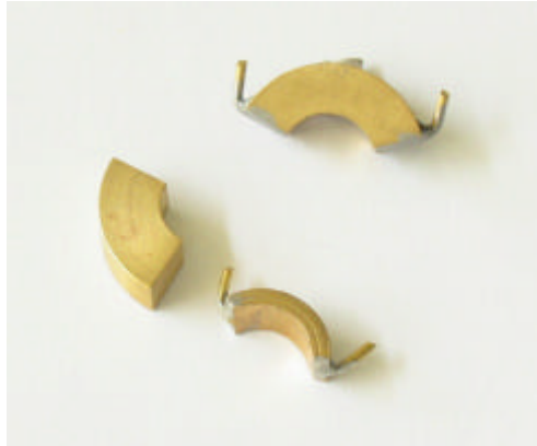
Abb. 8.10: Justierhilfe im neuen Elektrodenendteil. Die Scheibenstücke werden auf den Elektroden befestigt und ermöglichen ein Erfassen von Bereichen großer Apertur.
