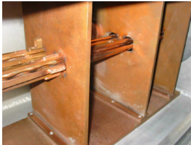
Abb. 6.7 zeigt den Übergang vom beschleunigenden Elektrodenabschnitt auf den Anpassungsteil (matching). Im hinteren Beschleuniger sind noch die unmodulierten Elektroden eingebaut.
