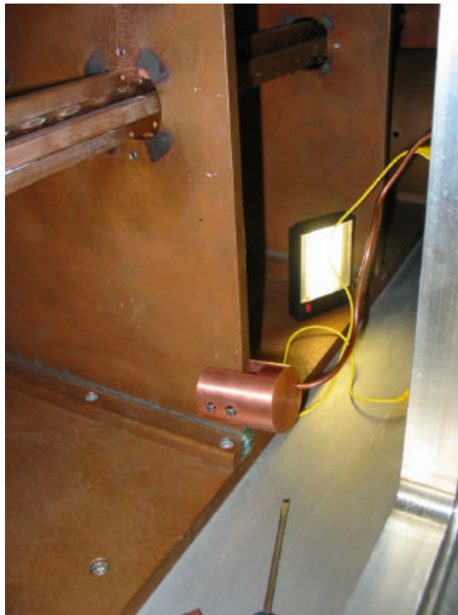
Abb. 8.11: Direkte galvanische Ankopplung an eine RFQ Stütze. Es wurde eine Anpassung von -38 dB erreicht.
