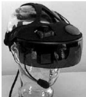
Abb. 2.4: Beispiel für Optical see-through HMDs [Sch04]
