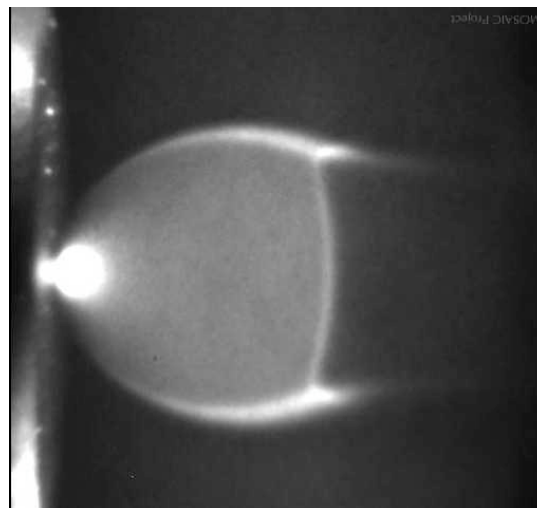
Abbildung 2.3: Rechts: Photographie eines Überschall-Gasjets aufgenommen mit einem \text{N}_2 -jet, gemischt mit 1 % \text{NO} , welches durch einen ArF-excimer Laser zum Leuchten angerecht.
