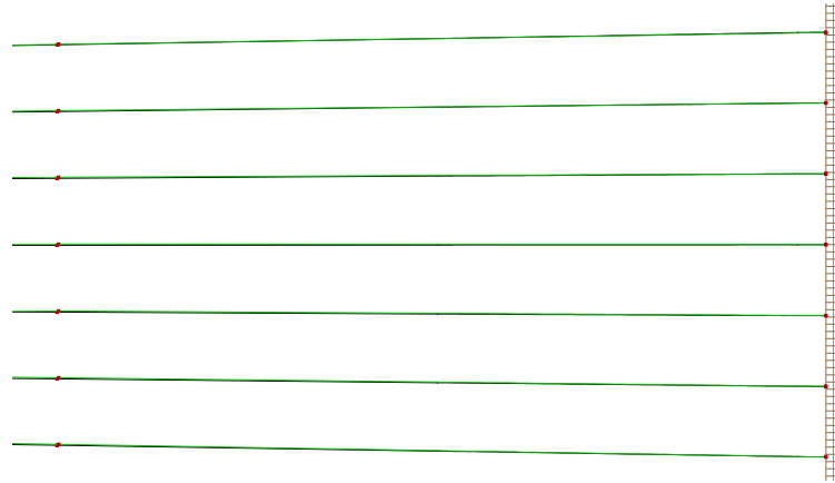
Abbildung 2.16: Blick auf den Detektorbereich eines Standardspektrometers in orts- und zeitfokussierender Geometrie (mit Linse und verlängerter Driftstrecke). Der Abstand von der Targetzone zum Eintritt in die Driftstrecke beträgt 298 mm; vom Targetort zum Detektor 1471 mm. Details zu den Trajektorien sind in der Bildunterschrift von Abbildung 2.10 zu finden.
