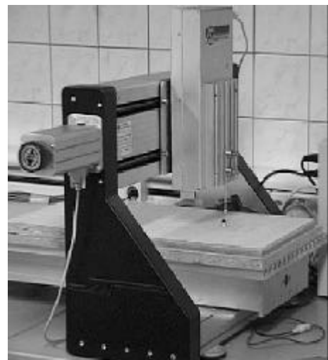
Abbildung 5. Versuchsaufbau für die Steifigkeitsmessungen.
